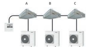
Lorsque différents systèmes d'un même local sont réunis au sein d'un groupe de contrôle (une télécommande), cette fonction permet une répartition des charges afin de faire fonctionner l'ensemble des systèmes de la manière la plus performante possible, malgré des conditions différentes (expositions,...).
