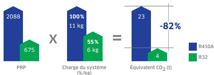
La réduction de l'impact du réfrigérant en équivalent CO<sub>2</sub> atteint jusqu'à **80%** du fait du passage au R32 !
