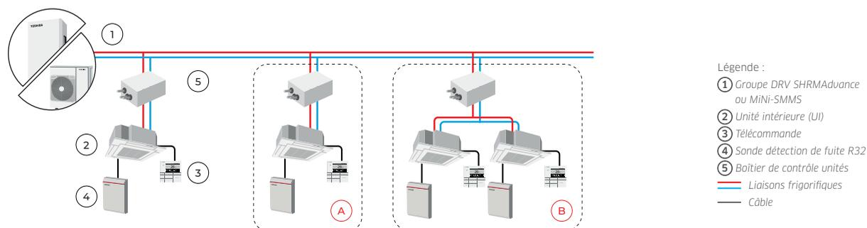
**Flexibilité totale de la gestion des fuites de réfrigérant grâce à trois niveaux d'activation des vannes d'isolement, dont :**
