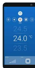
Application Bluetooth **Wave Commu Control** dédiée à l'utilisateur : On/off, température, mode, vitesse de ventilation, programmation...
